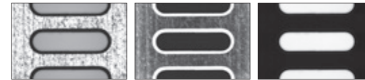
垂直落射照明 プログラム制御リング照明 透過照明
