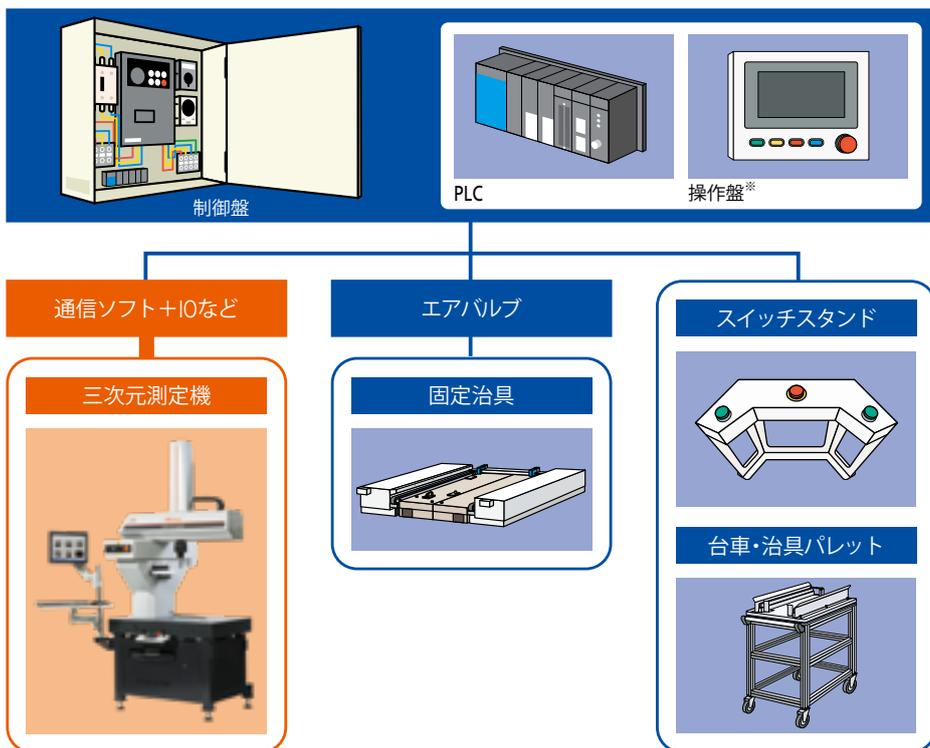
\*操作盤は、周辺機器との連動切替、測定対象ワーク切替、その他設定変更等に使用します。同一ワークの連続測定時には操作不要です。
