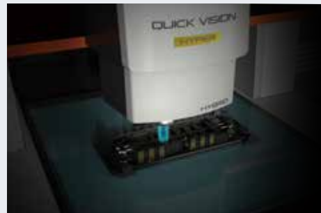
エンジンコントロールユニットの測定例
