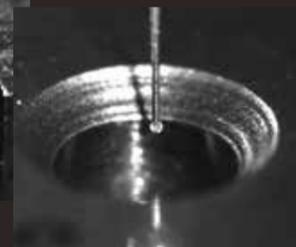
マグネット方式によるキネマティックジョイントの採用により、異なるスタイラスへの交換が容易に行えます。スタイラス交換工具 (MPP-NANOスタイラスツールセット) を標準装備。
