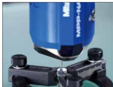
MPP-NANOによる非球面形状スキャンング測定
