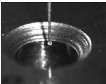
MPP-NANOによる微細孔形状測定
