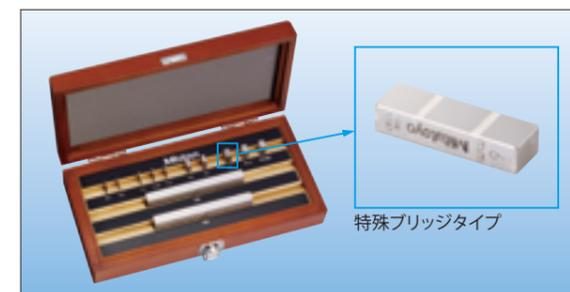
ゲージブロック比較測定機用校正マスタ
