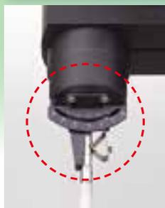
検出器部分に安全機構を搭載。検出器(縦姿勢時)にZ軸方向からの衝突に対し、衝突検知機能を搭載しました。また、検出器の変位がオーバーレンジした場合に動作を停止するアクシデンタルタッチ機能を搭載しました。アクシデンタルタッチを感知すると、専用解析ソフト(ROUNDPAK)がエラーを感知し、機械を自動停止します。
