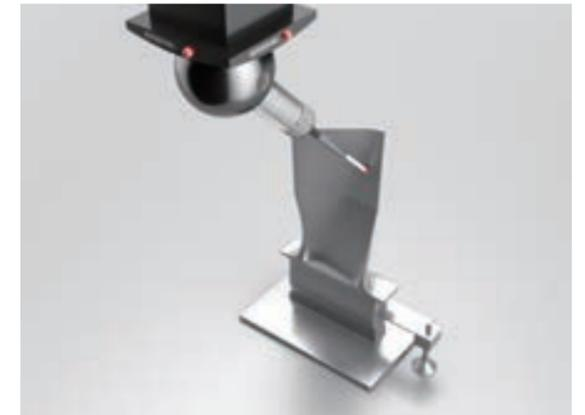
航空機エンジン用ブレードの断面を、小型・高精度スキャニングプローブで測定。鋳造品などの潜在的に誤差の大きいワークに対しても、速く安定した測定が可能です。
