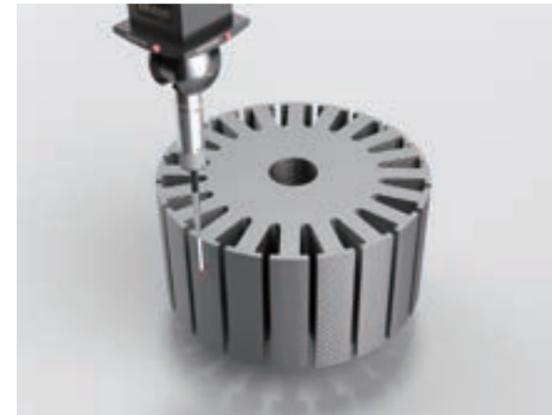
積層されたモータコアの真直度や断面形状等を測定。側面や任意の高さでの寸法測定など、立体物の測定に対応が可能です。
