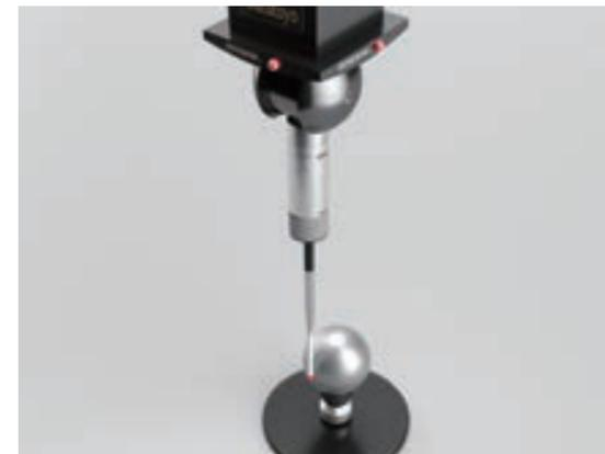
小型・高精度スキャニングプローブで、人工関節の自由曲面測定を実施し、取得した測定点群から3Dの誤差解析ができます。
