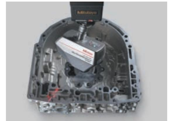
接触式プローブ(スキャニング)に比べ、非接触レーザープローブでは、圧倒的に測定時間を短縮できます。3方向からの一括スキャンで上面と内側を同時測定するので、姿勢変更回数が少なく、複雑な形状でも効率よく測定可能です。
