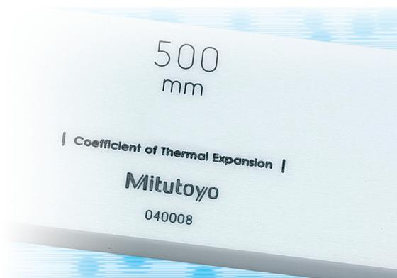
写真-45 熱膨張係数付ゲージブロック
