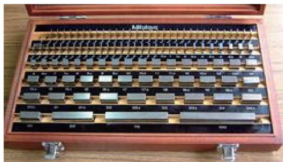
写真-30 103個組ゲージブロックセット(ミットヨ製)
