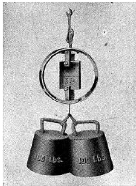
写真-2 ヨハンソンによる同学会での実験(密着力33気圧)
