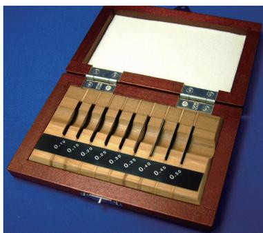
写真-33 極薄ゲージブロックセット
