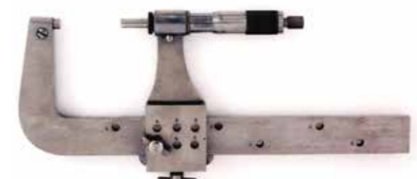
図56 スターレット社可動マイクロメータヘッド付ノギス（アメリカ） （測定範囲最大6 in）1920年
