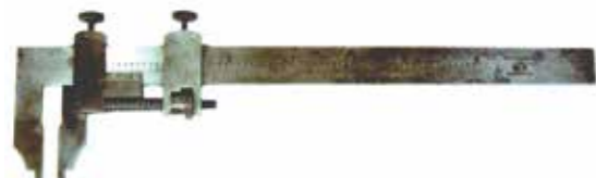
図50 スターレット社ノギス（本尺目量1/40 inをジョウ移動調節ねじ1回転25等分目盛による最小読取値1/1000 in）1900年頃
