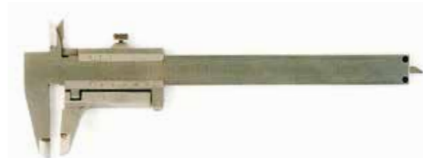
図59 ヘリオス社（ドイツ）スィベルジョウノギス （測定範囲5 in, 最小読取値1/128, 1/1000 in）1940年
