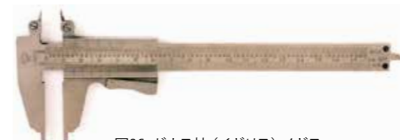
図96 ゼウス社(イギリス)ノギス (測定範囲140 mm, 5 in, 最小読取値0.02 mm, 0.001 in) 1950年
