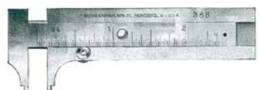
図17 ブラウン・シャープ社(アメリカ)簡易ノギス (最大目盛値4 in, 目量1/32, 1/64 in) 1924年
