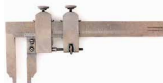
図23 ブラウン・シャープ社(アメリカ)簡易ノギス (測定範囲3 in, 目量1/32 in) 1910年, 同型1924年
