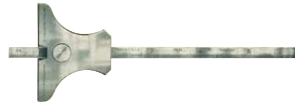
図69 ブラウン・シャープ社デプスゲージ (アメリカ) (測定範囲4.5 in, 目量1/32, 1/64 in) 1924年
