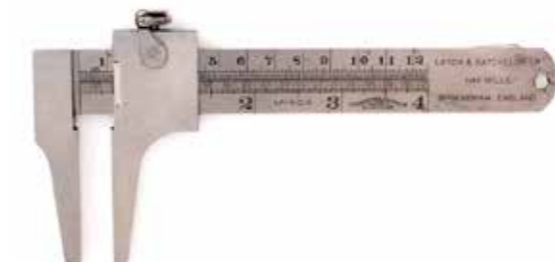
図32 チェスターマン・シェフィールド社（イギリス）簡易ノギス （測定範囲4 in、120 mm、目量1/32 in、0.5 mm）1900年
