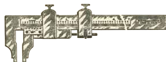
図61 マイクロ・プレジジョン・バーニヤ社（イギリス）ノギス（測定範囲5 in、最小読取値1/1000 in）1929年
