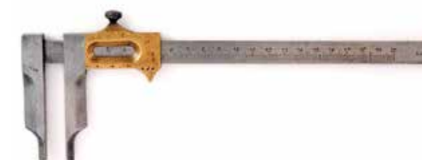
図39 ノギス (フランス製) (測定範囲150 mm, 19 mmを20等分し最小読取値0.05 mm) 1890年頃
