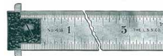
図20 スターレット社(アメリカ)調節可能フック付直尺 (最大目盛値6~48 in, 目量1/32, 1/64 in) 1927年
