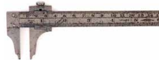
図36 シェフィールド社（イギリス）簡易ノギス （測定範囲5 in、13 cm、目量1/32 in、0.5 mm）1950年
