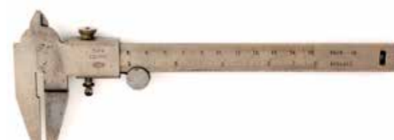
図33 パーカー社（イギリス）簡易ノギス （測定範囲5 in、130 mm、目量1/32 in、1 mm）1920年
