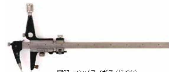
図97 コンパスノギス(ドイツ) (測定設定長6 in, 最小読取値0.001 in) 1950年
