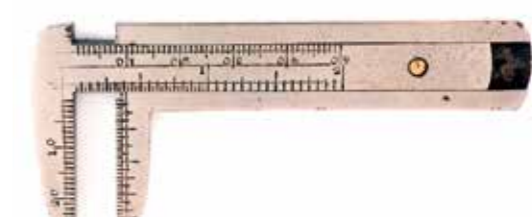
図35 コッテリル社（ドイツ）簡易ノギス （測定範囲2 in、50 mm、目量1/16 in、1 mm）1930年
