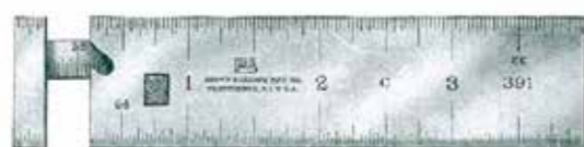
図17 ブラウン・シャープ社(アメリカ)簡易ノギス (最大目盛値4 in, 目量1/32, 1/64 in) 1924年
