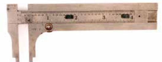
図27 スターレット社（アメリカ）ポケット型簡易ノギス （測定範囲4 in、下目量1/32 in、上円周目量1/64 in、1960年）
