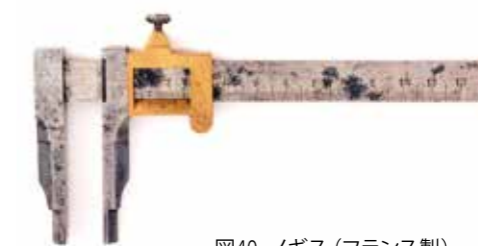
図40 ノギス (フランス製) (測定範囲100 mm, 最小読取値0.1 mm) 1890年頃
