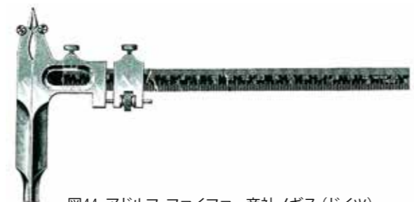
図44 アドルフ・ファイファー商社ノギス(ドイツ) (測定範囲 150 mm, 6 zoll, 最小読取値0.1 mm, 1/128 zoll) 1905年
