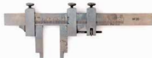
図25 スターレット社（アメリカ）滑り挟み尺 （測定範囲3~6 in、目量1/64、1/100 in）1890年、1927年
