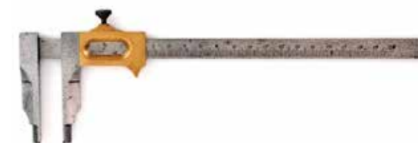
図38 ノギス (フランス製) (測定範囲150 mm, 9 mmを10等分し最小読取値 0.1 mm) 1890年頃
