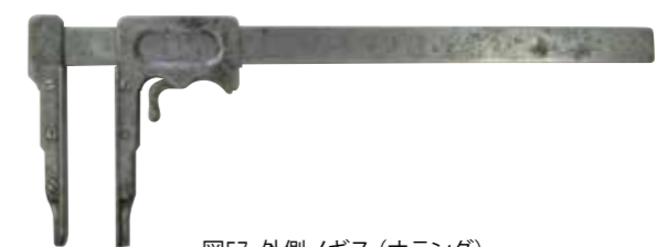
図57 外側ノギス（オランダ） （測定範囲6 in, 120 mm, 最小読取値1/128 in, 0.1 mm）1920年
