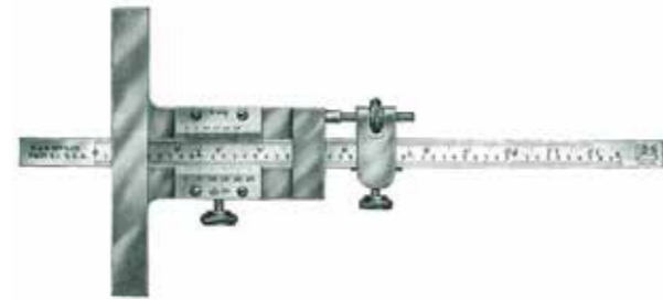
図70 ブラウン・シャープ社デプスゲージ (アメリカ) (測定範囲3 1/2 in, 88 mm, 最小読取値1/64, 1/1000 in, 0.02 mm) 1924年
