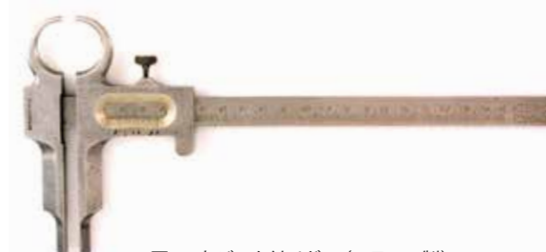
図41 丸ジョウ付ノギス (フランス製) (測定範囲150 mm, 最小読取値0.1 mm) 1890年頃
