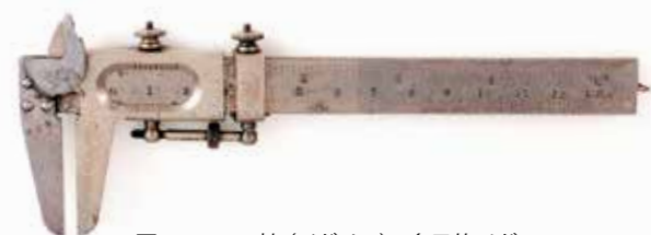
図42 ローコ社(イギリス) 多目的ノギス (デプスバー備、下最大目盛値120 mm, 上目盛5 in, 測定範囲100 mm, 4 in 最小読取値0.1 mm, 1/128 in(1/16 inの7目盛を8分割)) 1900年
