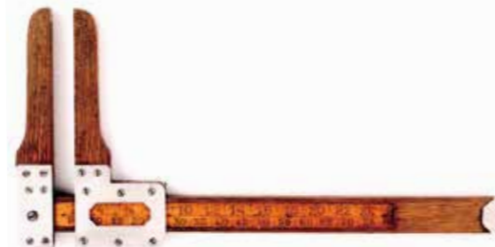
図29 木製滑り挟み尺（フランス製、上直径用目盛 目量1 cm 最大25 cm 下円周用目盛目量2.5 cm 最大80 cm）1930年
