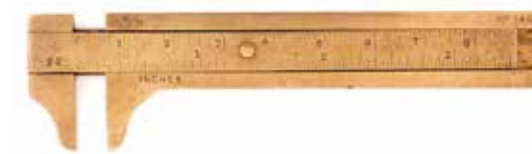
図34 ラボン・ソン社（イギリス）簡易ノギス （測定範囲3 in、80 mm、目量1/32 in、1 mm）1920年
