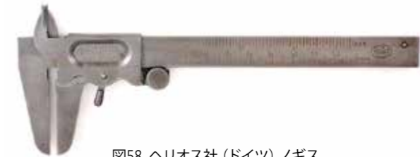
図58 ヘリオス社（ドイツ）ノギス （測定範囲120 mm, 4 in, 最小読取値0.1 mm, 1/128 in）1920年
