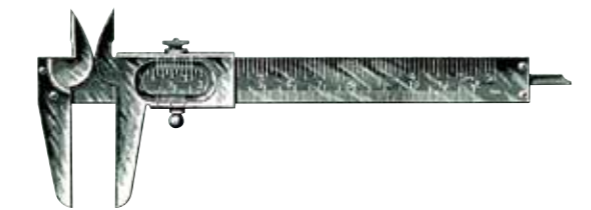
図45 アドルフ・ファイファー商社多目的ノギス(ドイツ) (デプスバーを備え、コロンプスノギスと名付く、測定範囲100 mm, 4 zoll, 最小読取値0.1 mm, 1/128 zoll) 1905年
