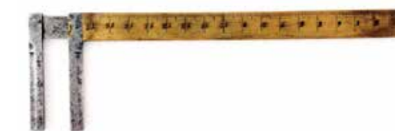
図8 鞞箱型滑り挟み尺, 簡易ノギス (ミリメートル及びプース目盛) (フランス製) 1840年頃
