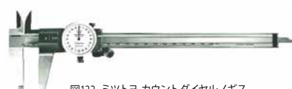
図123 ミットヨ カウントダイヤルノギス 測定範囲135, 190, 300 mm 1980年
