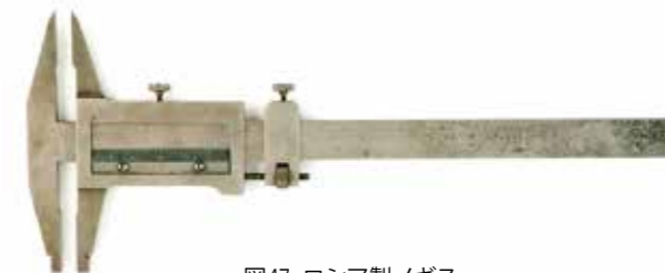
図47 ロシア製ノギス 測定範囲150 mm, 最小読取値0.05 mm(39 mmを20等分) 1910年
