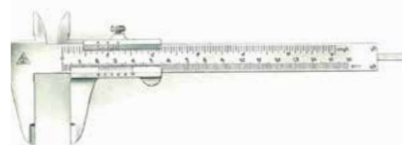
図62 カール・マール社（ドイツ）ポケットノギス（測定範囲120 mm、5 in、最小読取値0.05 mm、1/128 in）1931年
