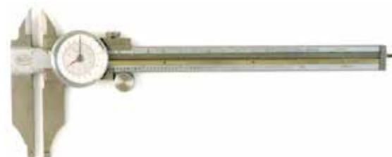
図115 ヘリオス社 (ドイツ) インチ・ミリメートル値同時表示 ダイアルノギス 1960年
