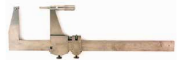
図55 ブラウン・シャープ社マイクロメータヘッド付ノギス（アメリカ） （測定範囲最大12 in）1920年
