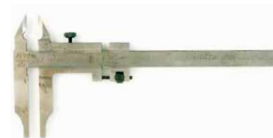
図66 ブランドロゴ CSE印製（ドイツ）ノギス（測定範囲5 in、最小読取値1/1000 in）1940年
