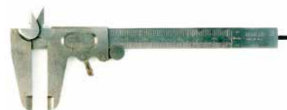
図31 ダンラップ社（アメリカ）簡易ノギス （測定範囲5 in、目量1/16 及び1/32 in）1920年
