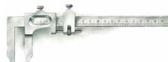
図63 カール・マール社ノギス（ドイツ）（測定範囲400、500、1000 mm、最小読取値0.1 mm）1931年
