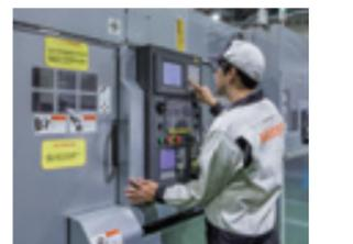
測定値が公差上限値と下限値の範囲内であるかを判別し、公差判定マークを表示。ひと目でOK/NGの判断が行えます。また、演算機能により測定結果から加工機への補正値を算出可能です。計算の手間や加工機に補正値を入力する際にプラスとマイナスを間違えるといったミスがなくなり、加工不良の削減に貢献します。
