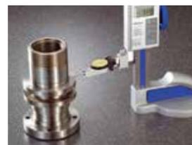
テストインジケータ取付けによる平面度測定
