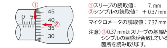
通常上図のように目量0.01 mmまで読み取ることができますが、下図のように目分量で0.001 mmまで読み取ることもできます。
