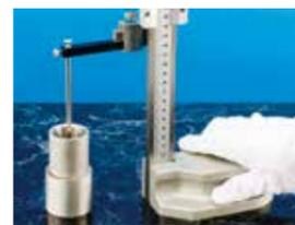
デプスアタッチメント取付けによる深さ測定
