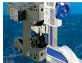
センタープローブ取付けによる多点の間隔測定
