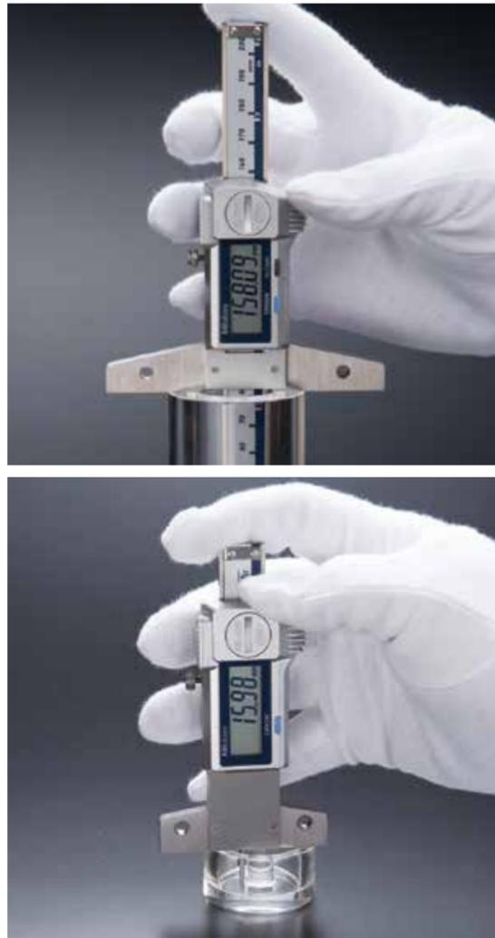
部分測定面接触誤差の最大許容誤差  $E_{MPE}$ 【JIS B 7518:2018】
