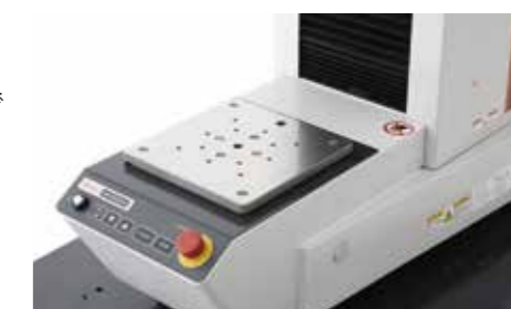
最大積載質量 100 kg 奥行(圧子中心より) 220 mm
