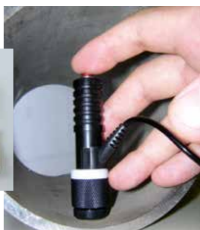
●パイプ内壁や狭い空間の硬さ試験
