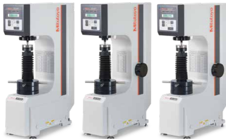
HR-320MS ツインタイプ(ロックウェル/ ロックウェルスーパーフィ シャル兼用)硬さ試験機
