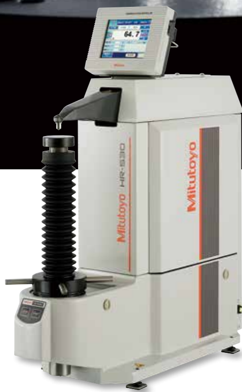
HR-530 ・最大試料寸法: 高さ250 mm、奥行150 mm
