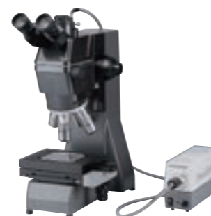
写真: FS70Z及びXYステージ装着例 (接眼レンズ・対物レンズ・レボルバ・照明装置はオプションです)
