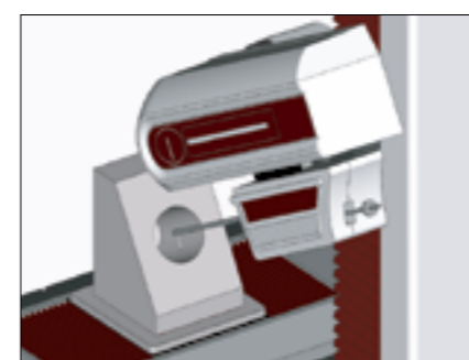
X軸方向の斜め穴測定
