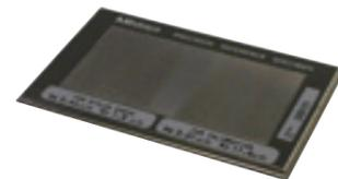
表示: Ra = 約3 μm、約0.4 μm
