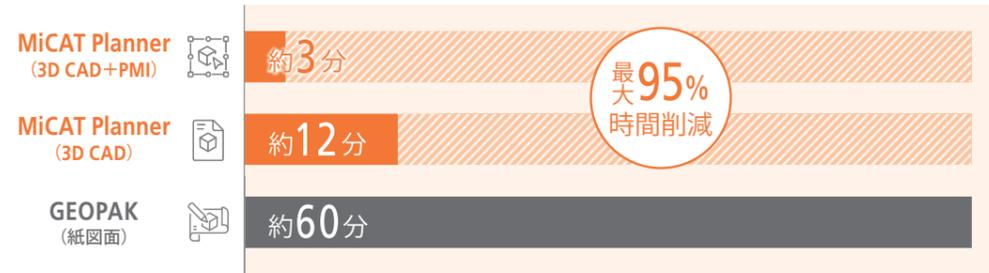
CADモデルの完成と同時に、最速で最適な測定プログラムが完成
