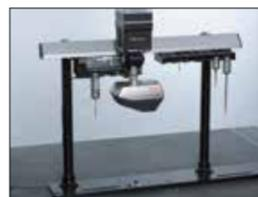
最大で720方向の位置決め制御により、複雑なワークでも最適な姿勢での高速スキニングが可能です。また、オートプローブチェンジャーACR3 を利用することで、“非接触測定 / 接触測定”を使い分けながらの全自動測定が可能になります。
