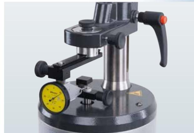
TIアクセサリセットの使用例(垂直形TIの場合)
