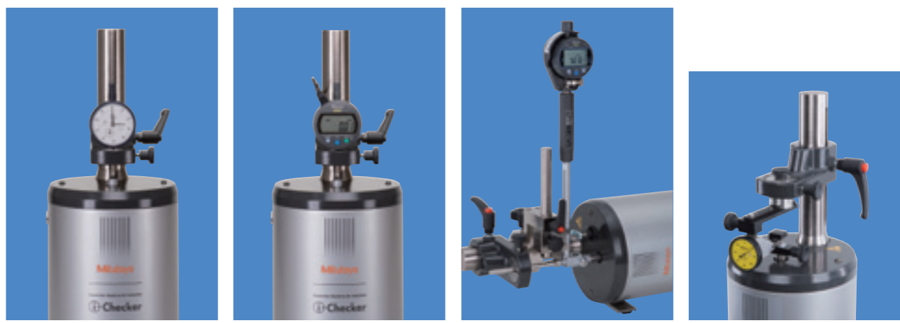
●アナログ式インジケータの検査 ●デジタル式インジケータの検査 ●シリンダゲージの検査 ●テストインジケータの検査
