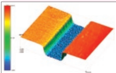
3Dデータからの表面解析 FORMTRACEPAK-PRO (オプション) 使用
